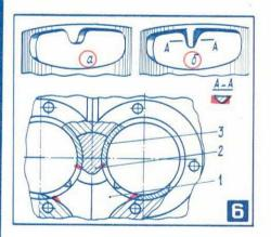
Тщательная ручная обработка каналов двухтактных двигателей позволяет повысить мощность, улучшить приемистость, уменьшить расход топлива.
